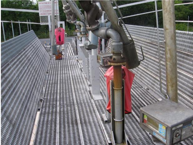
réserve, gère les accès aux produits, identifie électroniquement l'utilisateur ainsi que le véhicule et sauvegarde les transactions de chargement de vrac et de ravitaillement. Le système effectue également la lecture des informations nécessaires au suivi des inventaires de façon synchronisée selon une cédule préprogrammée.
